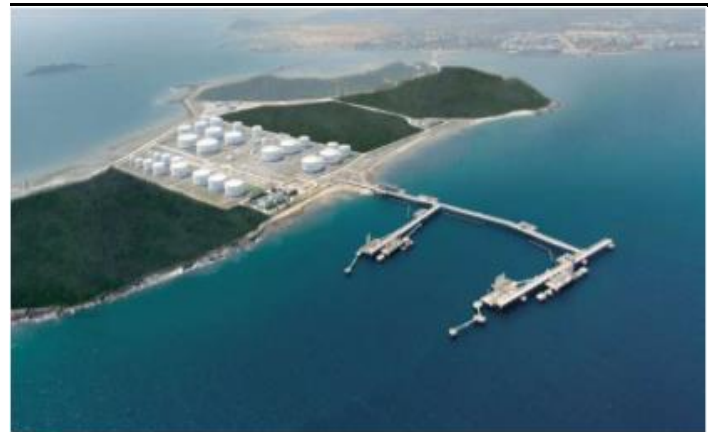
Hình 11: Kho cảng xăng dầu Vân Phong với sức chứa 505.000 m 3
