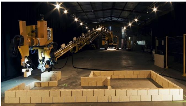
Hình 3. Robot xây dựng Hadrian (Nguồn: Fastbricks Robotics)
